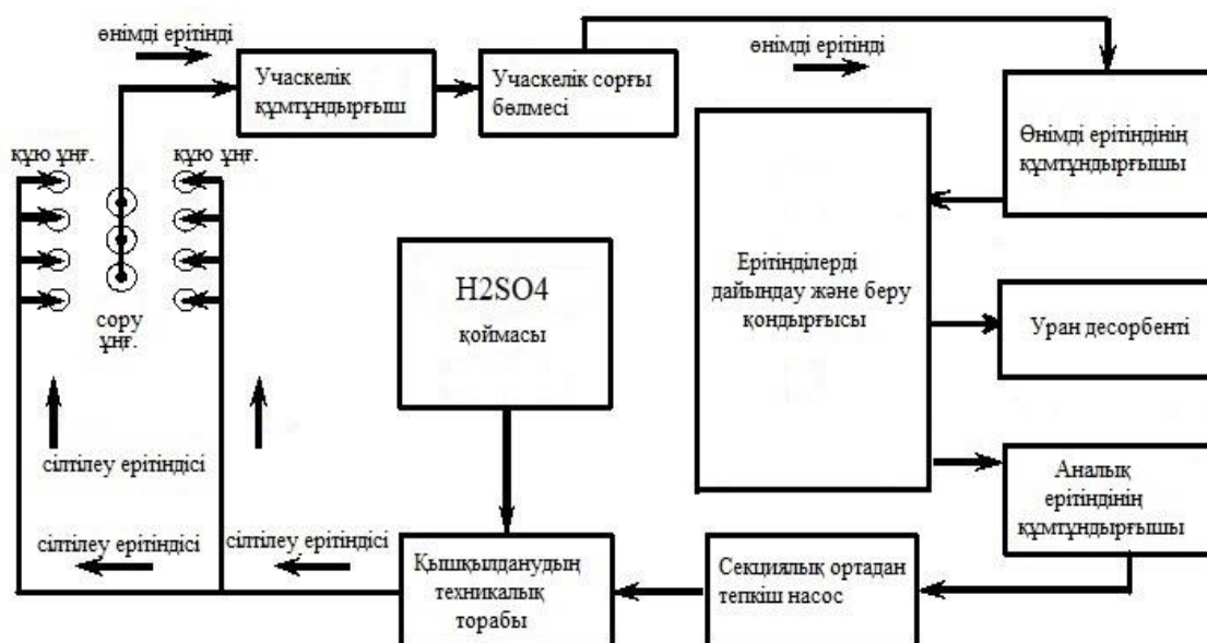
2 - сурет. Жерасты ұңғылап шаймалау әдісімен уран өндірудің технологиялық схемасы
